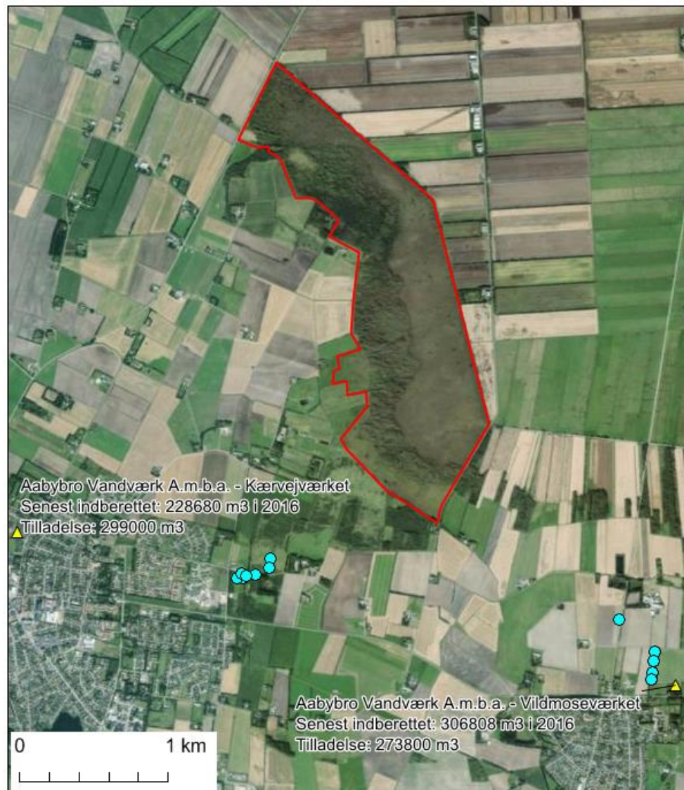
Figur 4-11 Større aktive indvindingsanlæg (gul trekant) og -boringer (lys blå prik) nær projektområdet.
