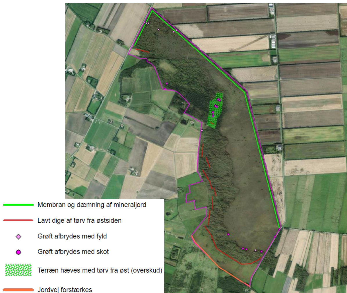
Figur 7-7 Foreslåede tiltag til at forbedre de hydrologiske forhold. Se også Bilag A. Tiltagene er overordnet set: a: etablere dæmning med bentonitmembran mod øst og nord, at lukke afløb og render fra højmosefladen, at bygge tørvevolde langs kanten af Delområde 2 samt at hæve/forstærke hjulsporet mod sydvest.
