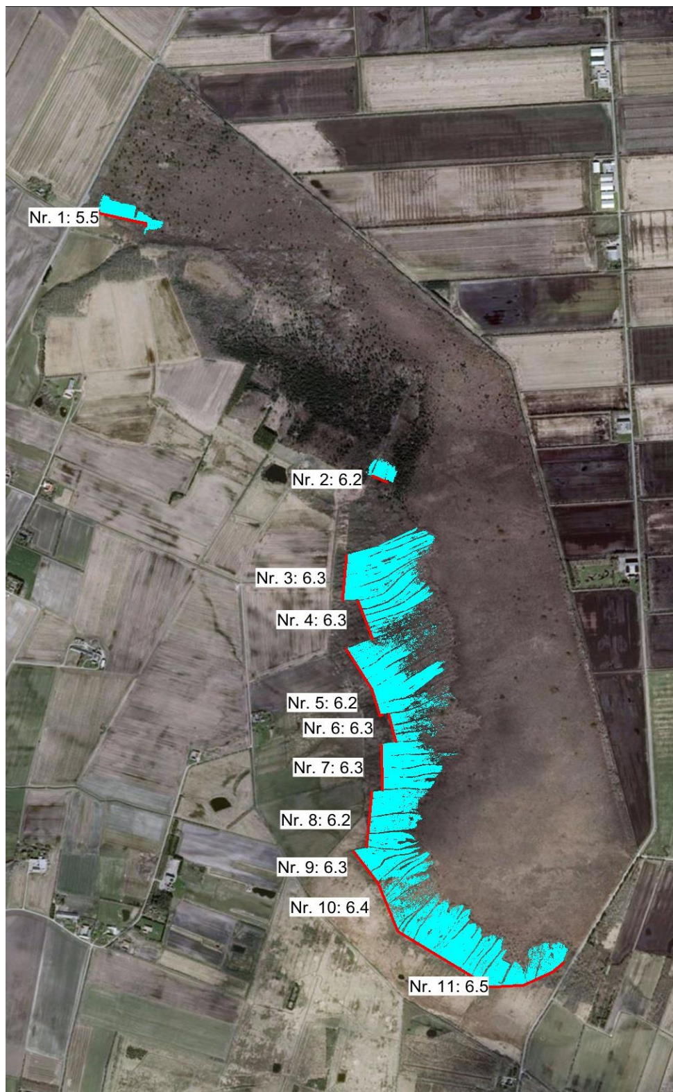
Figur 7-15 Lave diger mod vest. Lys blå angiver terræn under den angivne kronekote. Digerne anlægges med overhøjde, men det usikkert, hvor stor del af nedbøren og
