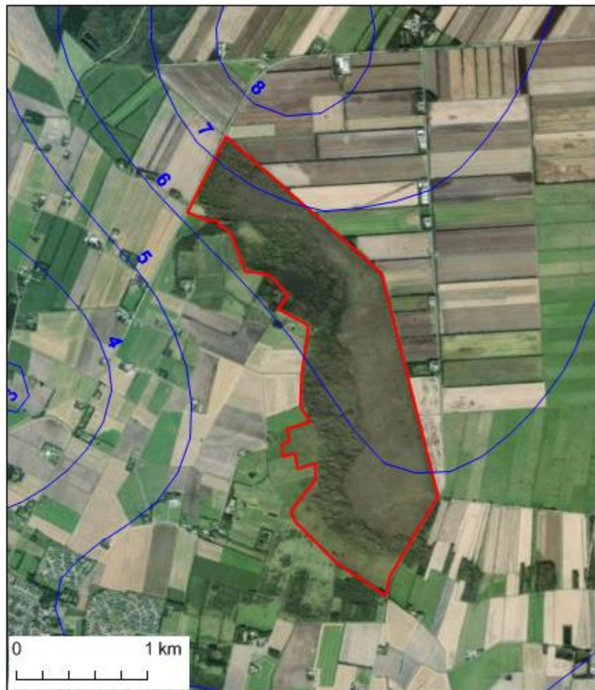
Figur 4-10 Nordjyllands Amts regionale potentialekort med isolinjer for hver meter.
