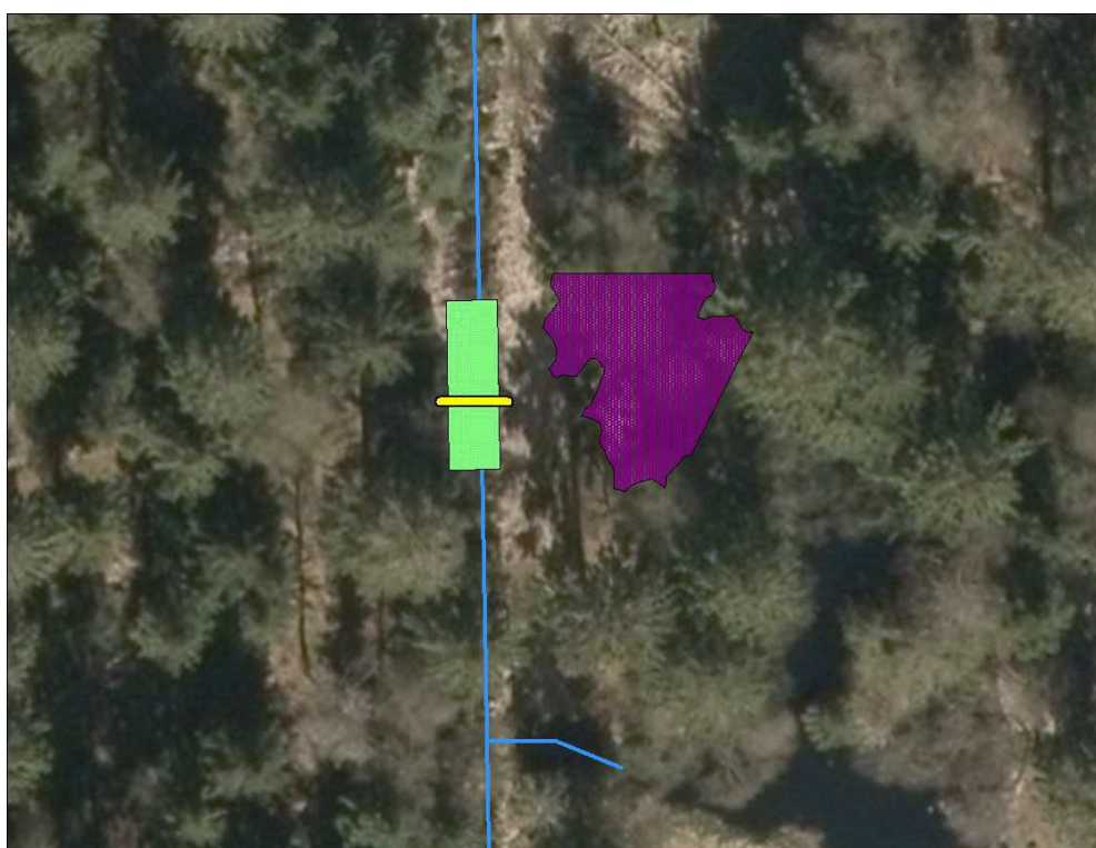
Figur 13. Skitse af det nye overløb i grøften med afløbet fra Sortemose med plastpladen vist med gul streg, området med bundudskiftning med grøn farve og udlægningsområdet for fyld med lilla farve i skala 1:500 på baggrund af GeoDanmarks ortofoto fra den 2. maj 2017, SDFE © og med vandløbet i blå streg.
