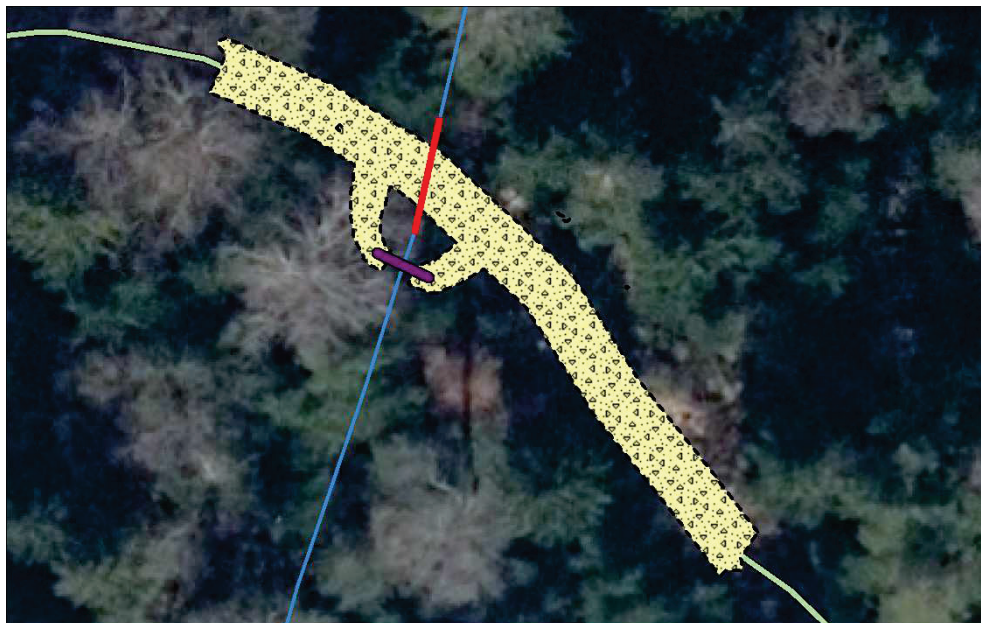
Figur 4. Tegning af det nye overløb i grøften fra den vestlige del af Hjorths Mose med plastpladen vist med lilla streg, den hævede skovvej med gul farve med trekantede prikker samt det nye 30 cm rør i rød streg i skala 1:400 på baggrund af GeoDanmarks ortofoto fra den 21. marts 2022, SDFI © (før rydningen) og med vandløbet i blå streg samt resten af adgangsvejen i bleggrøn streg.
