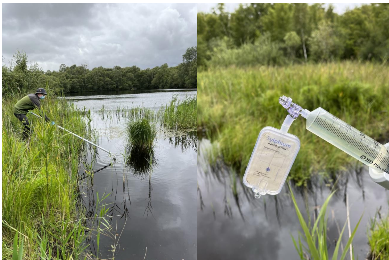
Figur 4.2: Indsamling af vandprøve fra tørvegrav 3 til filtrering igennem et Sylphium filter,
