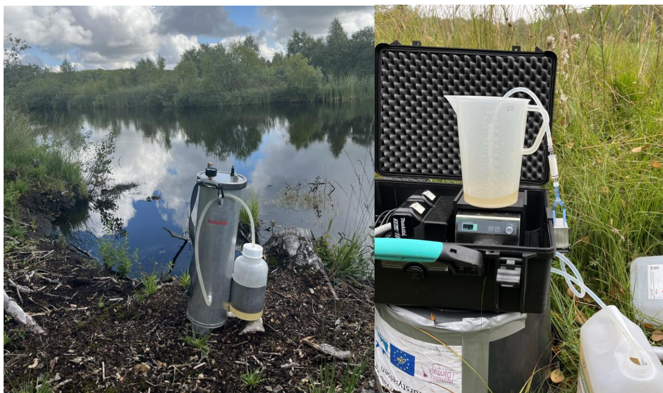
Figur 4.1: Tv. Tryk-assisteret filtrering ved tørvegrav 2. Th. Filtrering med peristaltisk pumpe ved tørvegrav 3.
