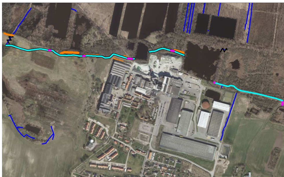
Figur 9. Det nye vandløbsforløb fra Glasværksengen til udløbet i søen i Skær 3 Syd er vist med lyseblå streg for de åbne strækninger og med lyslilla streg for de rørlagte strækninger. Terrænhævnninger er vist med orange farve, lukkede vandløb med sort zig-zag streg og de nuværende vandløb i mørkeblå streg på baggrund af GeoDanmarks ortofoto fra foråret 2019, ©SDFE og Danske Kommuner i skala 1:10.500.
