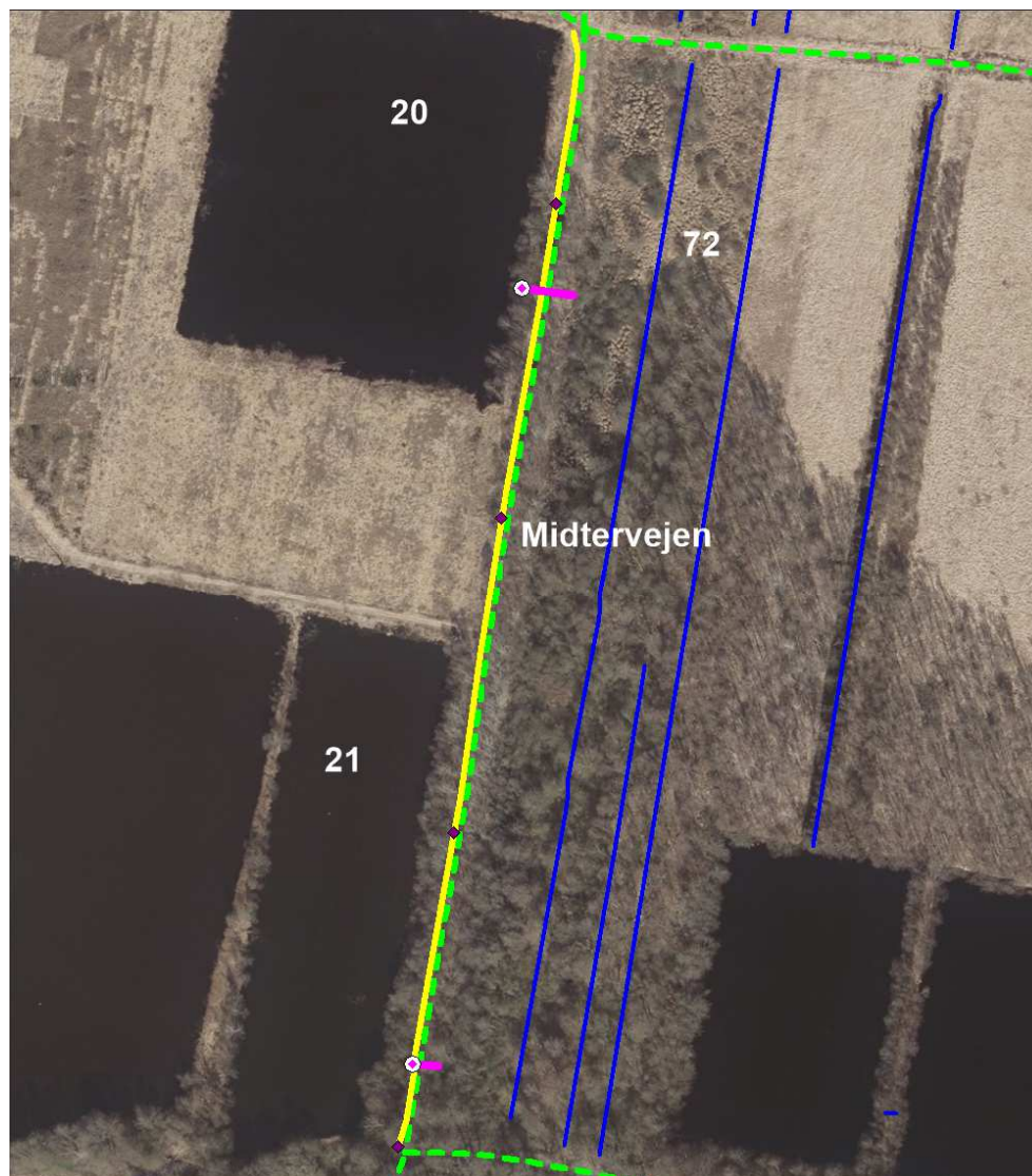
Figur 17. Forløbet af membranen langs Midtervejen i Holmegaard Mose vist med gul streg med mørke lilla stationeringsmærker per 100 m, nye rørledninger og overløb i lys lilla streg og cirkel samt med eksisterende grøfter med blå streg og adgangsveje i stippet grøn streg på baggrund af GeoDanmarks ortofoto fra foråret 2019, ©SDFE og Danske Kommuner i skala 1:2.500.
