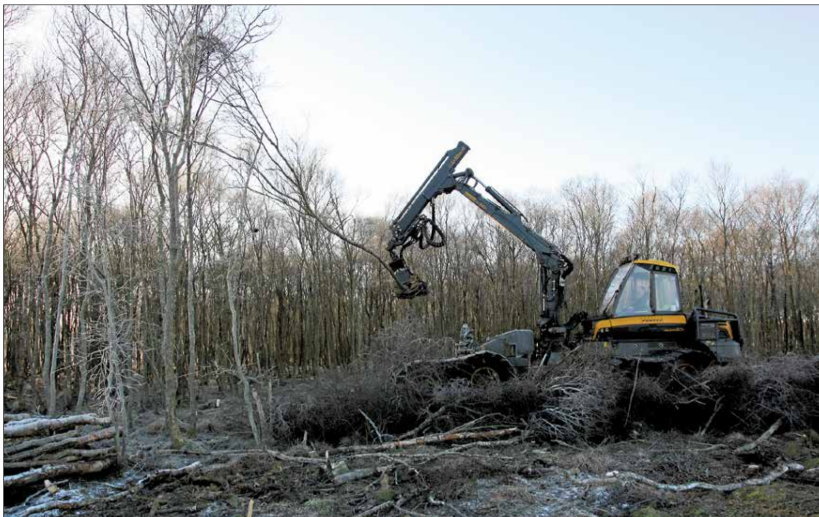
Når træerne skæres ned, bliver stammerne lagt foran maskinen. Derved fordeles vægten over et større område, bunden bliver hårdere og tørven skånes. Senere laves der flis af stammerne.
