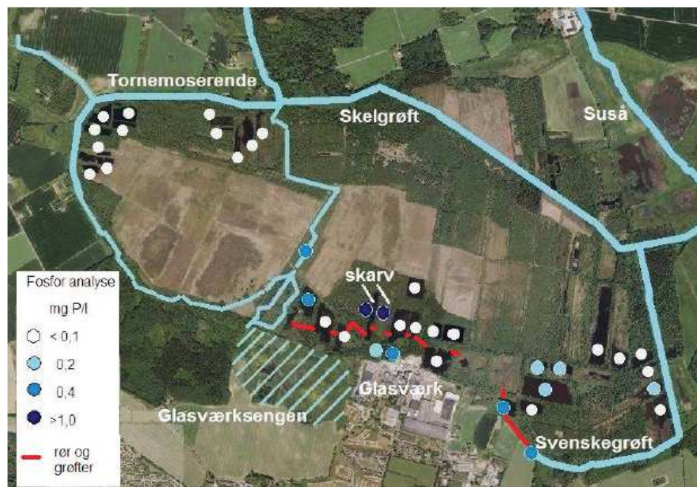
Figur 14 Feltmåling af orthofosfat i tørvegrave i Holmegaard Mose, december 2015. De røde streger angiver et muligt fremtidigt omløb af overfladevandet fra Trollesgave (Nielsen, 2016)
