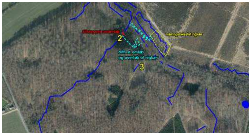
Figur 19 Skitse på baggrund af felttilsyn af, hvordan forureningen af Westphalerskæret er sket ved overløb fra den belastede grøft.
